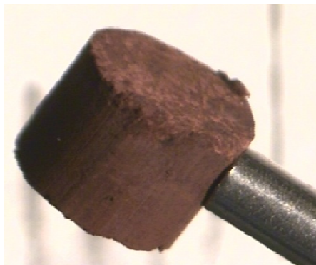
Massif de mousse métallique (thèse Sandrine Rocher)
